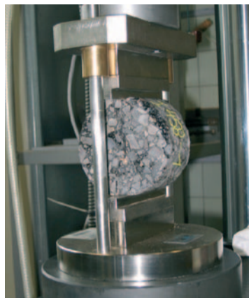
Figuur 1a en b: Proefopstelling voor de bepaling van de indirecte treksterkte.
