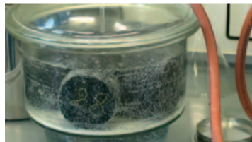
Figuur 3: Verzadiging in water bij 6,7 kPa van de asfaltproefstukken voorafgaand de conditionering in water.
