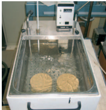
Figuur 2: Versnelde conditionering van asfaltproefstukken bij 40°C gedurende 72h.
